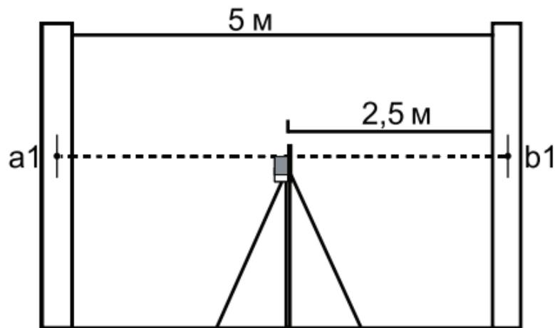
Пример: При проведении проверки лазерного построителя плоскостей, разница:  $\{a1-a2\} = 5$  мм и  $\{b1-b2\} = 7$  мм. Таким образом полученная погрешность прибора:  $\{b1 -b2\}-\{a1-a2\} = 7-5 = 2$  мм. Теперь Вы можете сравнить полученную погрешность, с величиной погрешности, заданной производителем.
